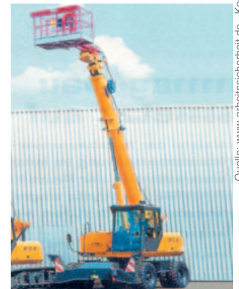
Bild 2-9: Kran mit Arbeitskorb
